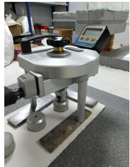
MULTICALCE – test trazione pull off
